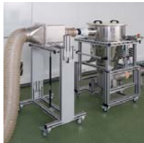
Aufbau eines Luftextraktions- Prüfstandes für luftführende Bauteile nach VDA 19.1 als weltweit erster Labordienstleister
