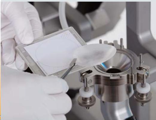
Die Saugextraktion direkt über die Filtereinheit bietet sich bei kleinen Flächen mit geringerer Partikelfracht, zum Beispiel im Prozessumfeld an Werkstückträgern oder auf Leiterplatten, an. Die Partikelgewinnung erfolgt schnell, sodass Prozessunterbrechungen minimiert werden.
