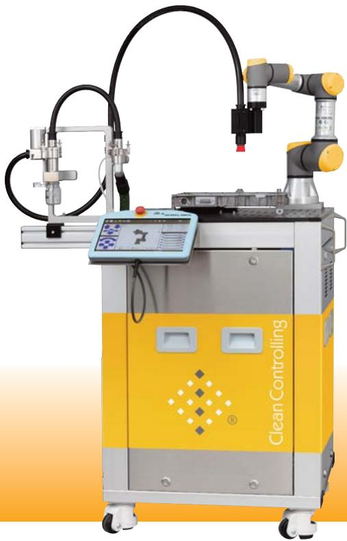
Das neuartige, robotergeführte Saugextraktionssystem **C|PS<sup>2</sup>robotics** ermöglicht die absolut reproduzierbare und wirtschaftliche Partikelextraktion für Sauberkeitsprüfungen von Bauteilen. Das Extraktionsverfahren des Partikelsaugextraktionssystem C|PS<sup>2</sup> bildet die ideale Basis für die Partikelgewinnung von den zu prüfenden Bauteilen, z.B. auch direkt im Prozessumfeld für in-line-Prüfungen.
