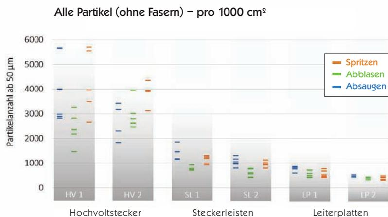
Die Bewertung zeigte, dass die größten metallischen Partikel von allen drei untersuchten Methoden zuverlässig extrahiert werden. Die Ergebnisse zeigen auch, dass Bauteile gleicher Charge zwar eine große Streuung besitzen, diese aber hinreichend einer Normalverteilung folgt, um daraus Mittelwerte und Standardabweichungen ableiten zu können.
